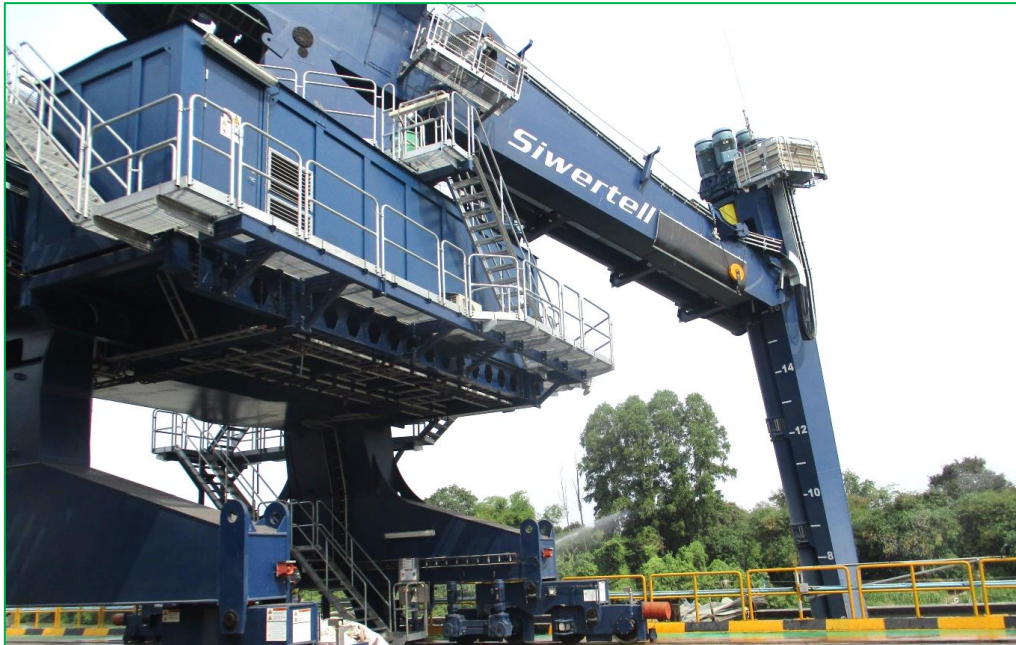
ภาพที่ 1.3 เครื่องจักรลำเลียงถ่านหินจากเรือแบบปิด (Screw Unloader)
